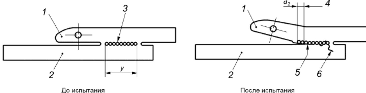
1 - муфта; 2 - труба; 3 - витки электронагревательной спирали; 4 - хрупкое разрушение в зоне сварки; 5 - разрушение в зоне спирали с пластической деформацией материала; 6 - пластическое разрушение трубы
