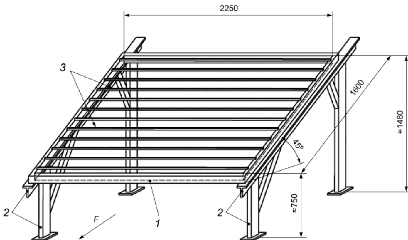
1 - съемная рама; 2 - опоры; 3 - съемные стержни для крепления образцов; *F* - направление расположения образцов к экватору
