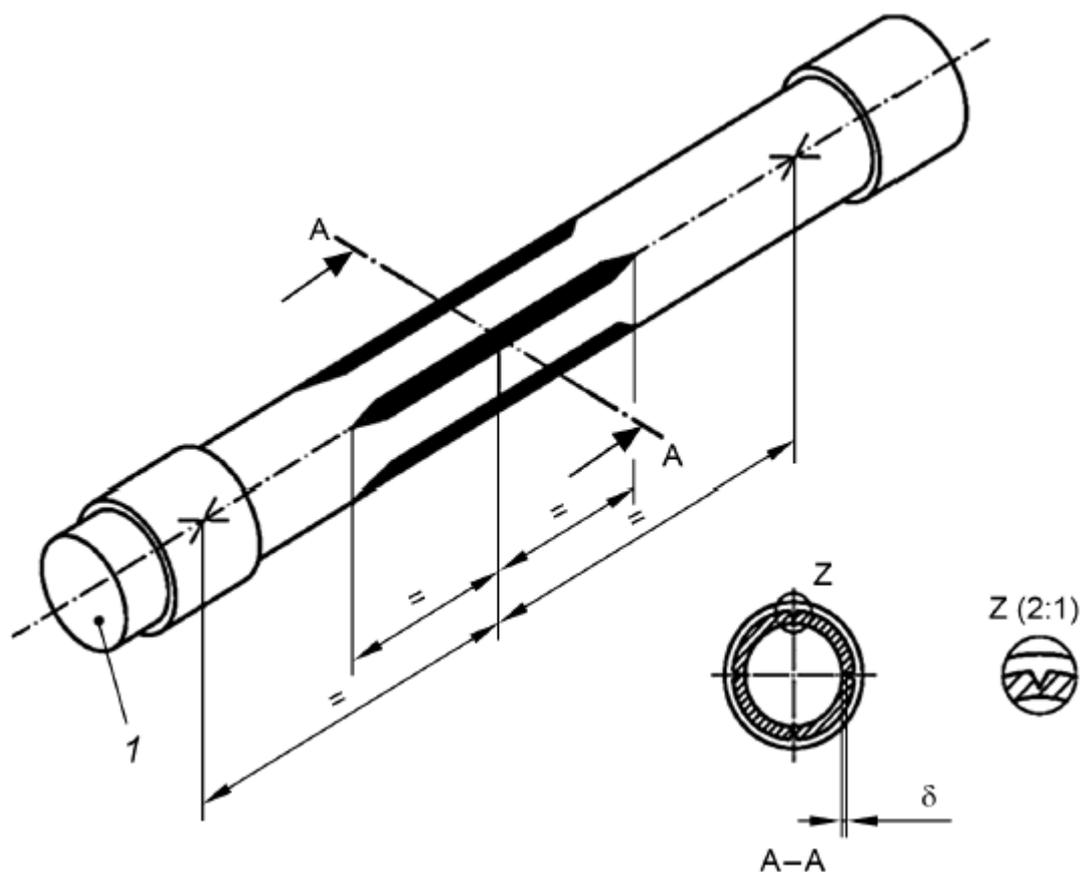
1 - заглушка;  $\delta$  - остаточная толщина, соответствует 0,78-0,82 номинальной толщины стенки
