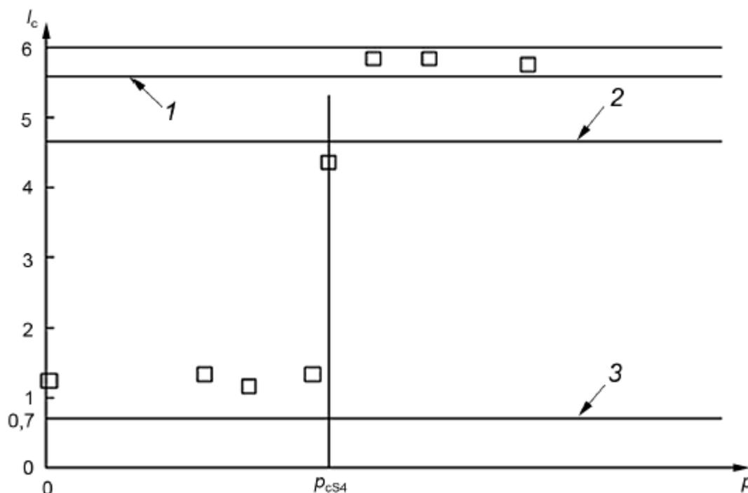
1 - минимальная расчетная длина; 2 - критическая длина трещины; 3 - минимальная длина трещины
