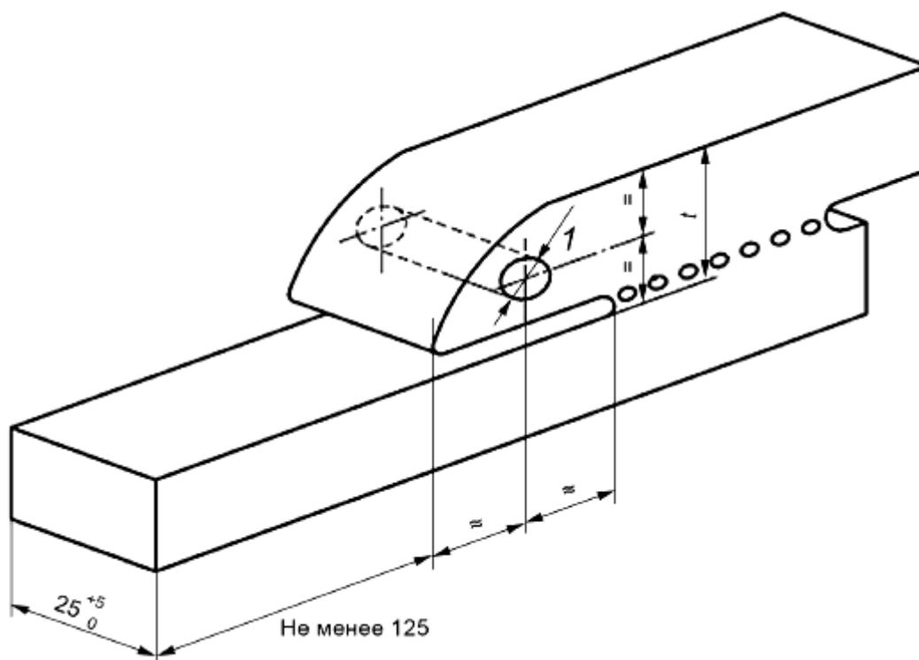
1 - отверстие для болта рычага, диаметром  $t/5$ , но не менее 3 мм
