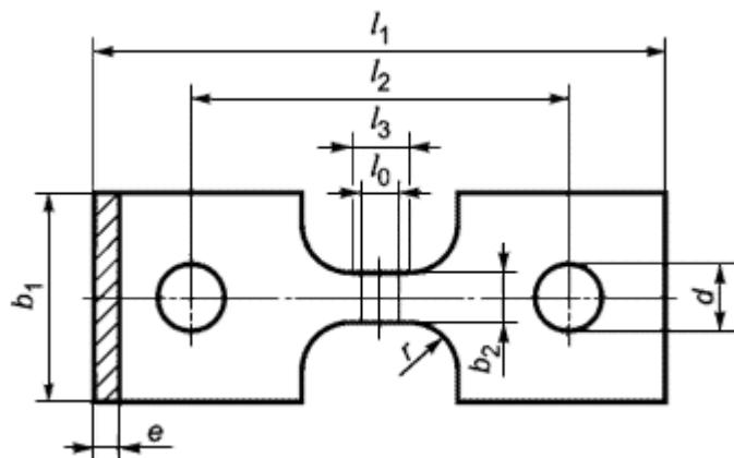
Рисунок 1 - Образец типа 3
